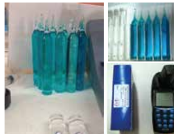
Figura 16. Fotografías de los análisis químicos, con el kit de química y fotómetro V-2000 de la marca Chemetrics
